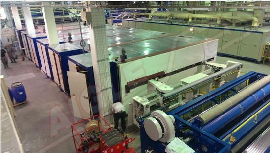
**Struktur des ÖFENS**, mit Seitentüren an den Seiten, die mit Silikongummidichtungen versehen sind, um einen leichten Zugang zum Innenraum zu ermöglichen. Sowohl die Seitentüren als auch der obere Teil bestehen aus verzinkten Blechpaneelen mit hochdichter Steinwolle.
