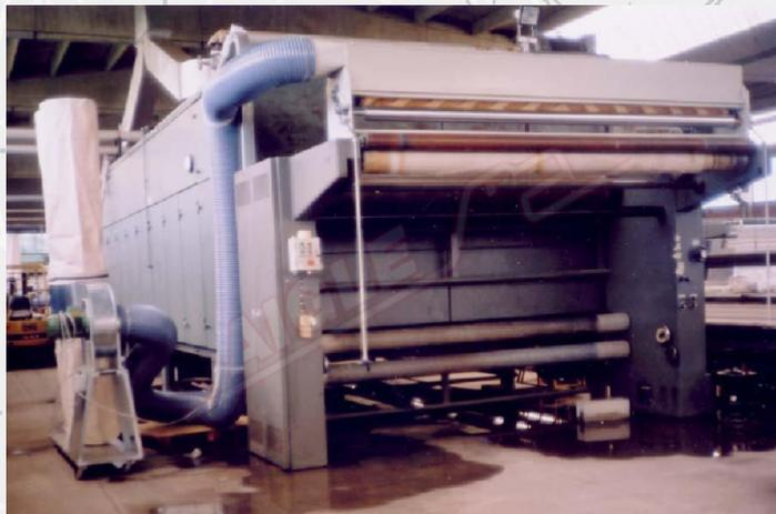
Die **Beflockung Gruppe mod. TC2** kann kombiniert werden mit einer **Glitter Distribution Unit mod. TDP** (siehe Schema unten).
