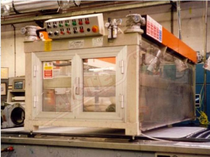
Сайт **ФЛОК для ротационной печати мод. TC2/COMPL** размещается на плечах ротационной трафаретной печатной машины. В месте разделения ткани и конвейерной ленты расположен отсос для предварительной очистки, окончательная очистка производится щеточной машиной, расположенной на выходе из ПЕЧИ.
