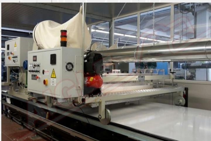
Сайт **Тележка ФЛОК мод. TCR/COMPL** должна быть собрана на концевых плечах машины плоской трафаретной печати. Тележка ФЛОК движется вперед-назад по двум рельсам, установленным на плечах печатной машины. Скорости тележки и печатной машины синхронизированы. Пока ткань останавливается между фазами печати, тележка укладывает ФЛОК на лежащую под ней ткань.
