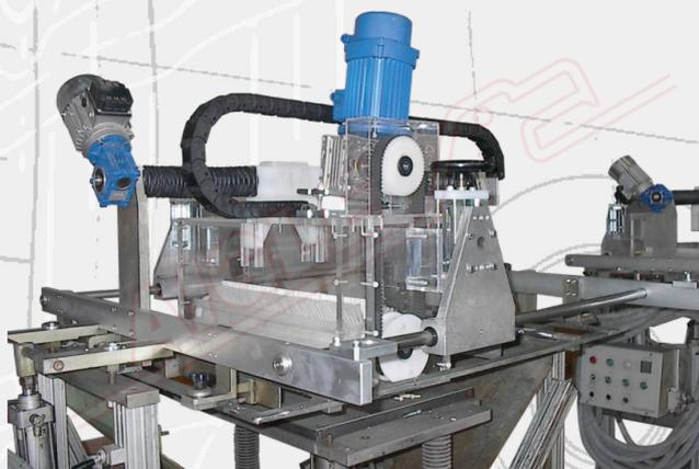
Il sistema di **Floccaggio Multicolore per Linee da Stampa a Quadro mod. LFM** si compone di una o più unità da montare sulle singole stazioni di una qualsiasi macchina da stampa a quadro serigrafico.
