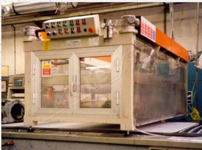
Il **Gruppo di Floccaggio per Stampa Rotativa mod. TC2/COMPL** è montato sulle spalle di una macchina da stampa rotativa. Nel punto in cui il tessuto viene staccato dal tappeto, è posta una lama aspirante per la pulizia preliminare; la pulizia finale viene effettuata tramite la spazzolatrice all'uscita del forno.
