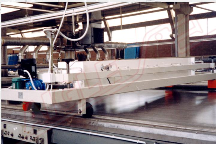
Il **Carrello di Floccaggio mod. TCR/COMPL** viene montato sulle spalle finali di una macchina per stampa piana e scorre avanti e indietro su due rotaie, poste alle estremità delle spalle stesse. La velocità del carrello e della macchina da stampa sono sincronizzate; durante la fase di arresto del tessuto tra le stampate, il carrello procede a floccare il tessuto sottostante.
