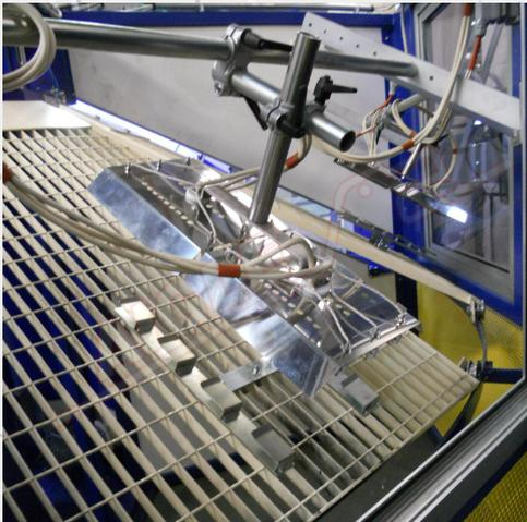
L'avantage du processus semi-automatique est le rendement élevé en termes d'unités, par rapport à la main-d'œuvre, c'est-à-dire sa productivité. Il y a également moins de déchets/ rebuts en raison du nombre réduit de manipulations des pièces d'une phase à l'autre, et enfin de la constance de la production en termes de qualité. Elle emploie également des robots pour accroître l'automatisation du processus.
