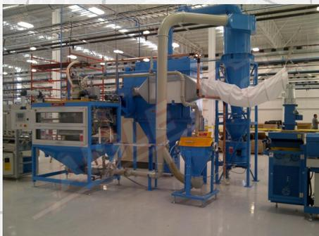
Les **Machine à floquer mod. FR1/R** peuvent être utilisés indépendamment ou combinés, soit avec un ou plusieurs modules, afin d'obtenir des vitesses de flochage plus élevées, soit avec un module Flocking Machine. FR/ESP pour le flochage des profils de contre-dépouille.
