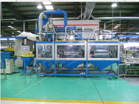
Una sección de distribución de flocado, compuesta por una tolva de flocado longitudinal que contiene un cepillo giratorio. El cepillo se opone a un armazón de malla metálica que puede retirarse fácilmente para su limpieza. La velocidad de rotación del cepillo puede ajustarse y un sistema motorizado permite ajustar también la altura de la tolva en relación con el perfil.
