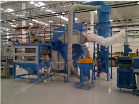
El **Máquina de flocado mod. FR1/R** pueden utilizarse de forma independiente o combinadas, ya sea con un módulo o más, para obtener velocidades de flocado superiores, o con una flocadora mod. FR/ESP para el flocado de perfiles socavados.
