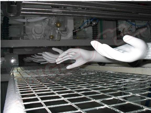
Am Ende des Prozesses, nach der letzten Reinigung, um den überschüssigen Flock zu entfernen, wird der Handschuh umgedreht, so dass sich die beflockte Seite auf der Innenseite befindet.
